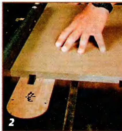
Перевернув заготовку, параллельные пазы выбирают пазовым диском.
