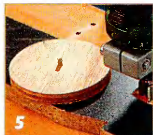
Вспомогательная доска с двумя вырезами под упорно-направляющий штифт и фрезу обеспечивает необходимый радиус при обработке колёс фрезерованием.
