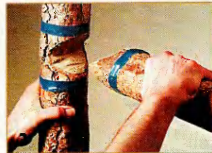
Клинообразные пазы, уменьшающие толщину детали, делать не следует.
