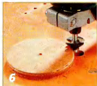
Колесо обтачивают фрезой, медленно вращая его в направлении, противоположном направлению вращения фрезы.
