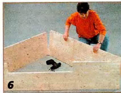
6 Наружные стенки соединяют, используя угловые трехгранные планки сечением 38x38 мм. Здесь — пробная сборка. Окончательно ящик собирают непосредственно на месте, то есть на балконе или террасе.
