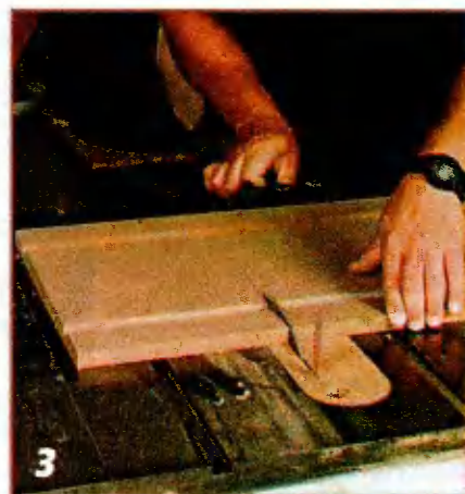
После распиливания заготовки пополам получают заготовки для основания и платформы.
