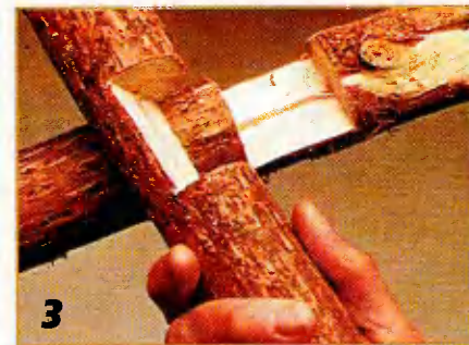
Выборку пазов для соединения вполдерева производят пилой и стамеской.
